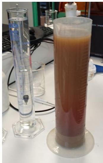
Figure IV-24 : densim tre plong  dans l'eau d ionis e (  gauche) et  prouvette de s dimentation (  droite).
