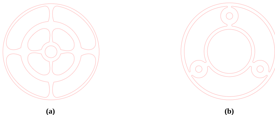
Figure IV-2 : profil des pièces découpées en PMMA pour maintenir les électrodes planes à une distance contrôlée, (a) première version et (b) deuxième version (utilisée avec les plantes également).
