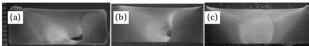
Figure 1.17 – Macrographie de joint FSW fait de l’alliage 2014 dans leur section transverse (a) pion cylindrique, (b) pion à conicité, (c) pion fileté [90].
