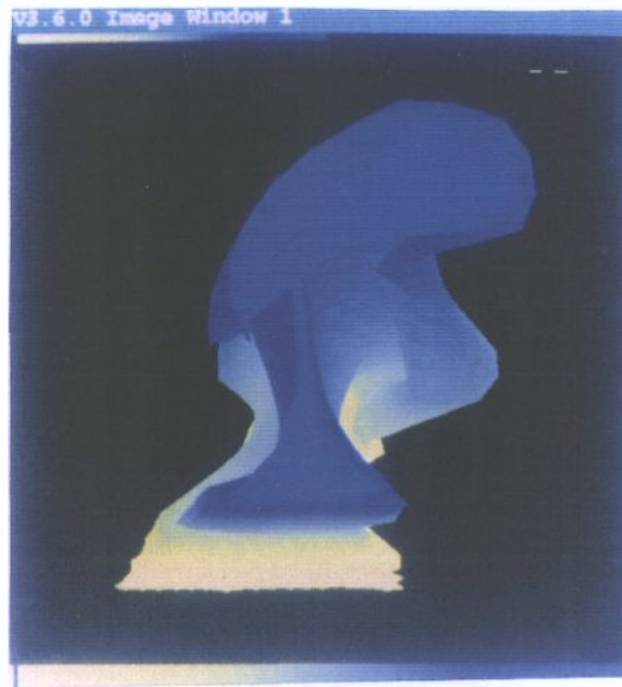
Photo. III.6 : Reconstruction d'une évolution de structure cohérente. Vue longitudinale aval. L'écoulement est orthogonal à la prise de vue. Mauvaise fermeture par le squelette
