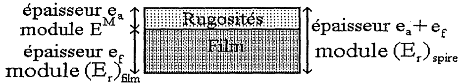
Figure V.13 : Couplage de REUSS entre le film et les rugosités
