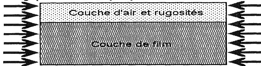
Figure A.12 : couplage parallèle d'une couche d'air et d'une couche de film
