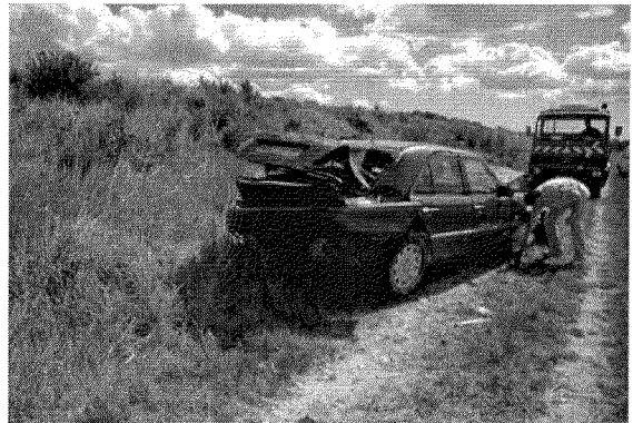
Figure 9-11 : Plan de l'accident perte de contrôle Mercedes C 250 D et photographies des traces sur la chaussée et de la position finale et déformations du véhicule sous différents angles
