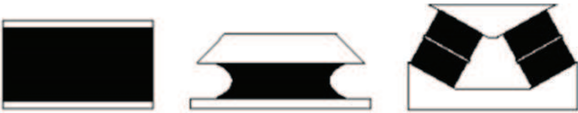
FIGURE 1.26: Exemples d'isolants vibratoires : en noir le polymère, les parties blanches indiquant les parties métalliques
