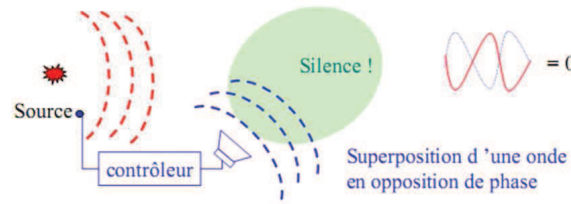
FIGURE 1.22: Absorption acoustique par contrôle actif
