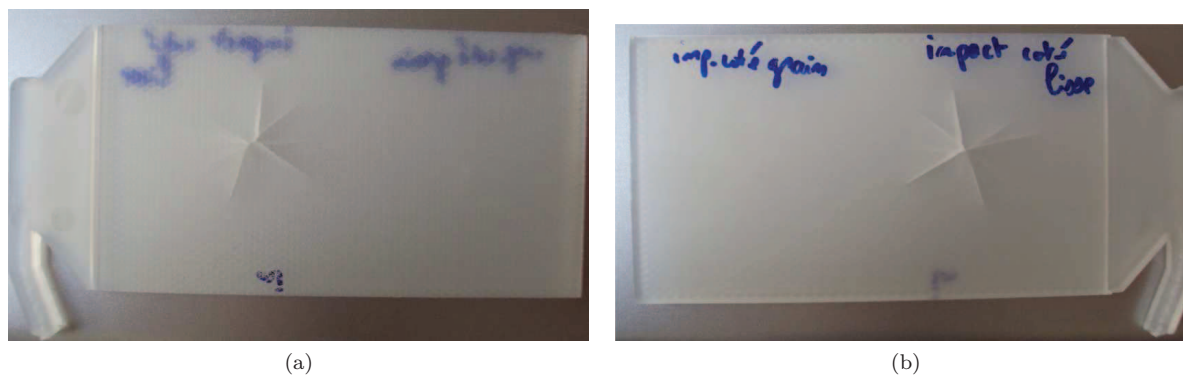
FIGURE 4.40: Epreuve de choc PP pour E_{imp}=2 J, formation de fissures pour l'impact côté lisse (configuration 2)
