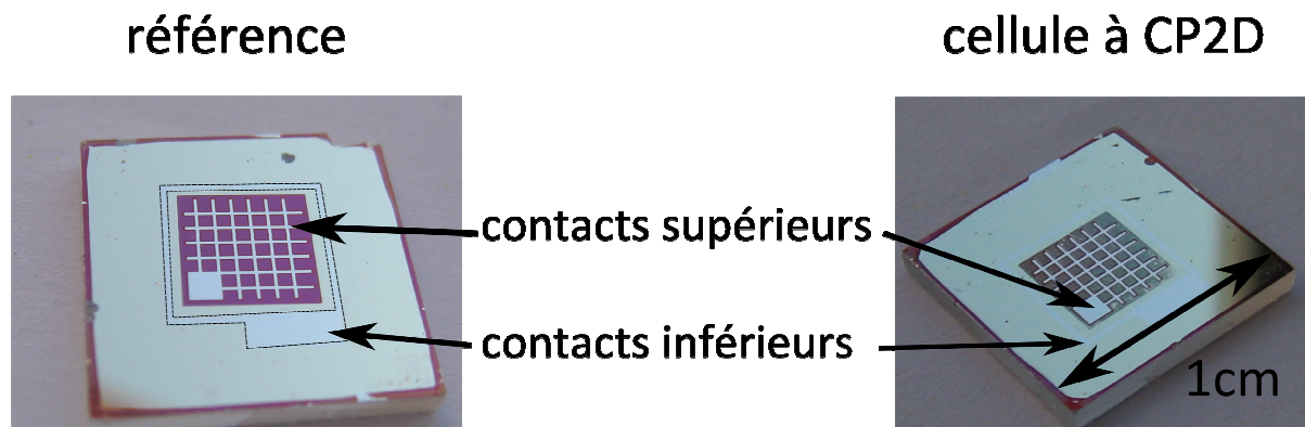
Figure 5.13: Photographies d'une cellule de référence (à gauche) et d'une cellule « photonisée » intégrant un CP2D (à droite) obtenues en fin de fabrication. Pour plus de clarté, le contour des contacts inférieurs a été tracé pour la cellule de référence.
