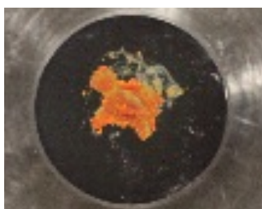
Figure V-82 : Amas de particules solides extraites du mélange ternaire contenant Mo-organique+ZDDP(II)+triamine.
