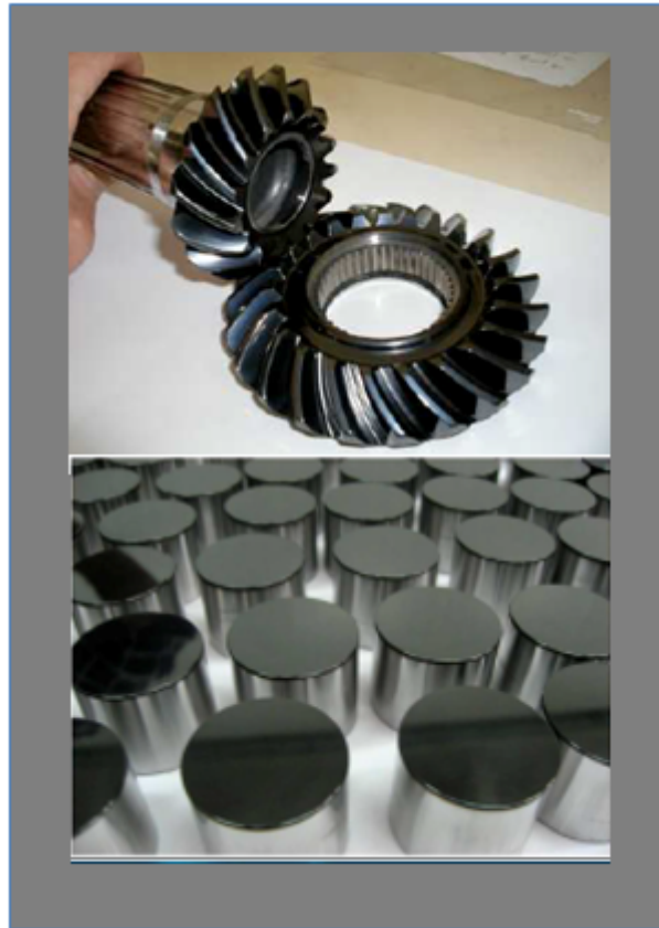
Figure 24 : Photographies de différentes pièces automobiles revêtues de DLC : a) poussoirs pour moteur et b) engrenages coniques pour transmission (documents fournis par IREIS).
