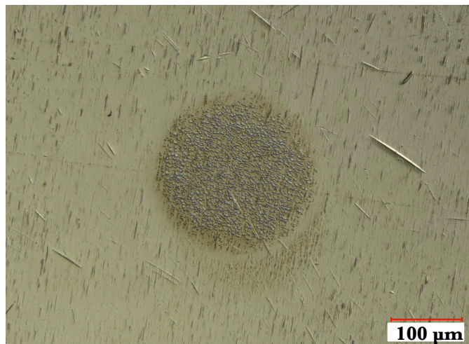
Figure III-43 : Photographie obtenue par microscopie optique de la trace de frottement sur la bille issue du contact acier/NCD en présence du binaire : Mo-organique+ZnDTP(II).
