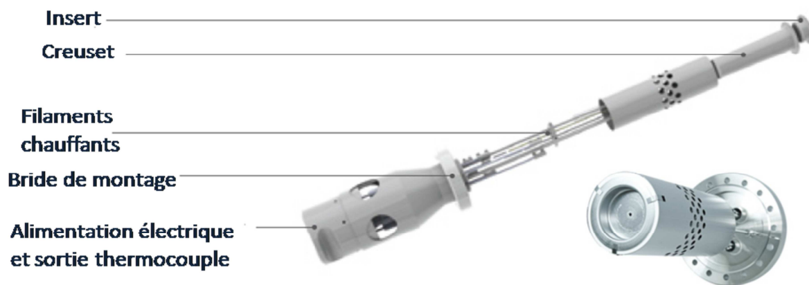
Figure II.21 : Schéma d'une cellule double zone et photo de la cellule RIBER DZMM avec insert.
