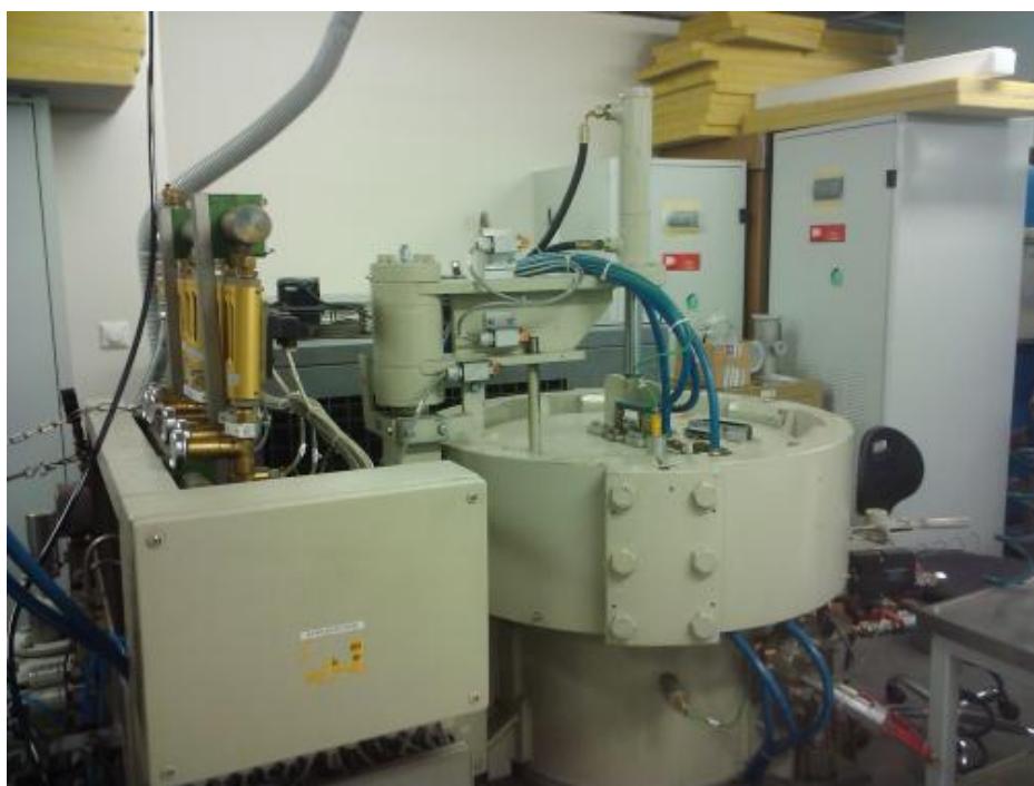
Figure III-2 : Four de frittage (HIP) des WC [TUT].
