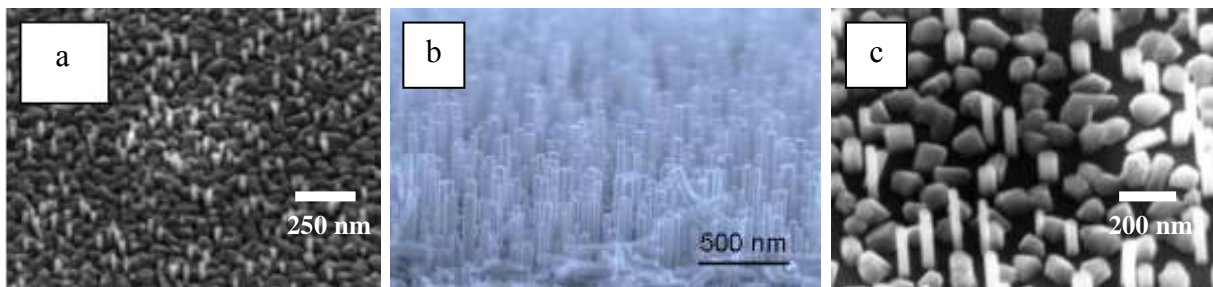
Figure 3.37: NFs d'InP auto-catalysés obtenus selon deux régimes de croissance différents: (a) et (b) régime « 2D/3D » avec un faible P_V/P_{III} < \sim 40 et avec respectivement de faibles P_{In}(F_{In}) et P_{P2} (C4) ou de fortes P_{In}(F_{In}) et P_{P2} (C16), (c) régime « cristaux 3D » avec un fort rapport P_V/P_{III} > \sim 40 et une faible P_{In}(F_{In}) (C6).
