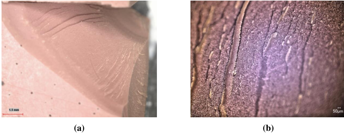
Figure 70 – Observation par microscopie (a) binoculaire et (b) numérique du faciès de rupture du cône de cisaillement pour la matrice phénolique à l'état brut sous l'impact d'une chute de masse à 4 J
