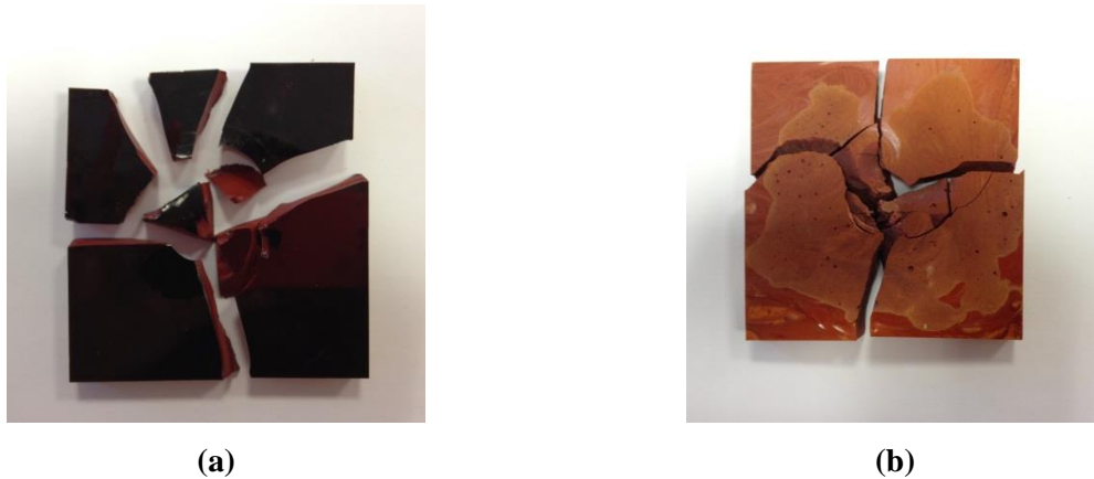
Figure 76 – Observation visuelle de l’endommagement sur la face supérieure de (a) la matrice phénolique et de (b) la mousse syntactique phénolique à l’état stabilisé (60°C) sous l’impact d’une chute de masse à 4J.
