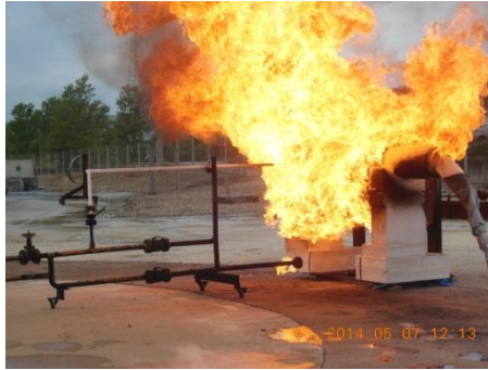
Figure 14 – Formation de la boule de feu par l'emploi d'une chambre de recirculation.
