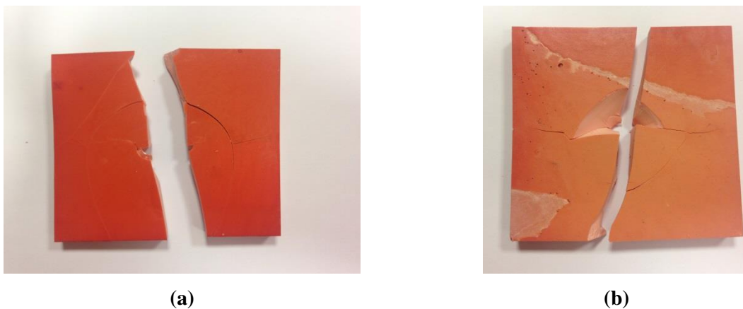
Figure 69 – Observation visuelle de l'endommagement sur (a) la face supérieure et (b) la face inférieure de la matrice phénolique à l'état brut sous l'impact d'une chute de masse à 4 J.
