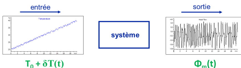
Figure 1 – Schéma du flux de signal dans un appareil DSC appliqué au TOPEM®. T_0 est la température initiale, \delta T est la perturbation stochastique de la température et \Phi_m est le flux de chaleur mesuré.
