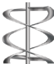
Figure 36 – Exemple d'un double ruban hélicoïdal [51].
