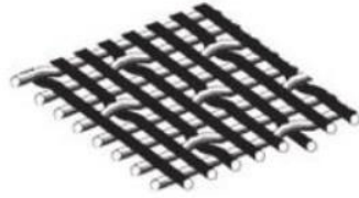
Figure 5 – Configuration de tissage de l’armure satin 8 [9].
