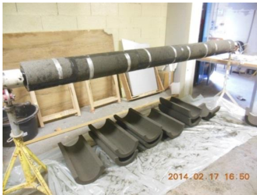
Figure 4 – Mise en place des demi-coquilles de verre cellulaire pour la fabrication du prototype industriel.
