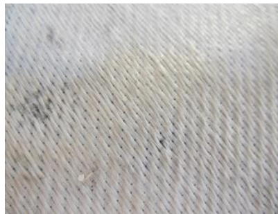
Figure 22 – Etat général du composite stratifié après l'essai jet fire.
