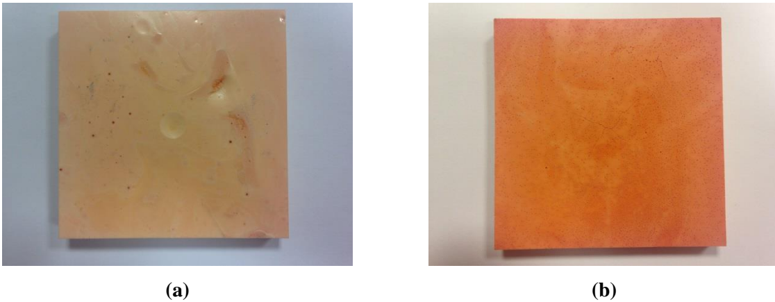
Figure 72 – Observation visuelle de l'endommagement sur (a) la face supérieure et (b) la face inférieure de la mousse syntactique phénolique à l'état brut sous l'impact d'une chute de masse à 6 J.
