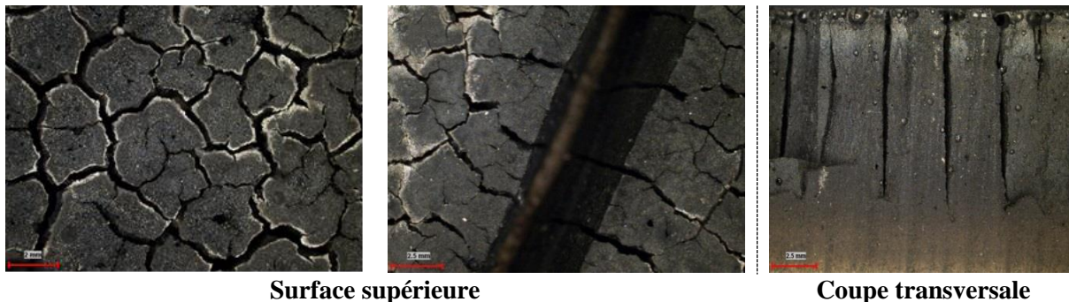
Figure 33 – Observation par microscopie binoculaire de la surface supérieure et de la coupe transversale du char de la MS-50% après exposition au feu.
