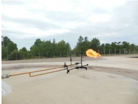
Figure 17 – Dispositif d'installation du flux de gaz de propane.
