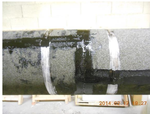
Figure 4 – Mise en place des demi-coquilles de verre cellulaire pour la fabrication du prototype industriel.
