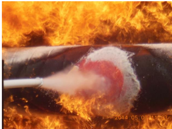
Figure 18 – Projection de propane liquide en sortie de buse.
