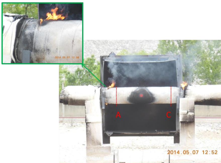
Figure 19 – Etat du prototype industriel à l'arrêt de l'essai jet fire.
