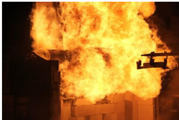
Figure 13 – Photographie d’un essai jet fire réalisé sur un système tubulaire par la société SINTEF (Image SINTEF).
