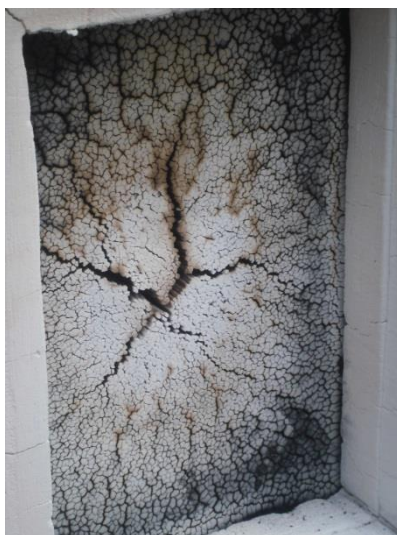
Figure 42 – Etat de l'éprouvette MS-30% avec agent ignifugeant après le test au feu.
