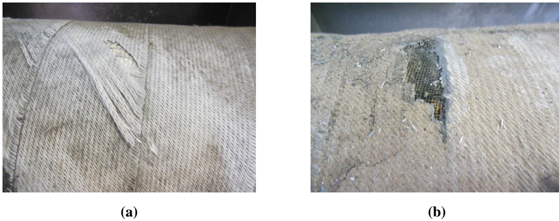
Figure 23 – Présence de défauts sur le composite stratifié.
