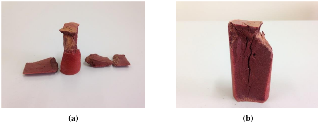
Figure 50 – Faciès de rupture macroscopique de la mousse syntactique à l'état stabilisé (60°C) après un essai de compression uni-axiale.
