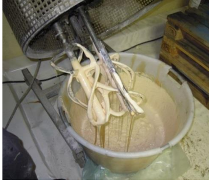
Figure 34 – Photographie du mélangeur à mouvement planétaire avec deux doubles rubans hélicoïdaux utilisés pour la fabrication de la mousse syntactique dans le cadre de la thèse.
