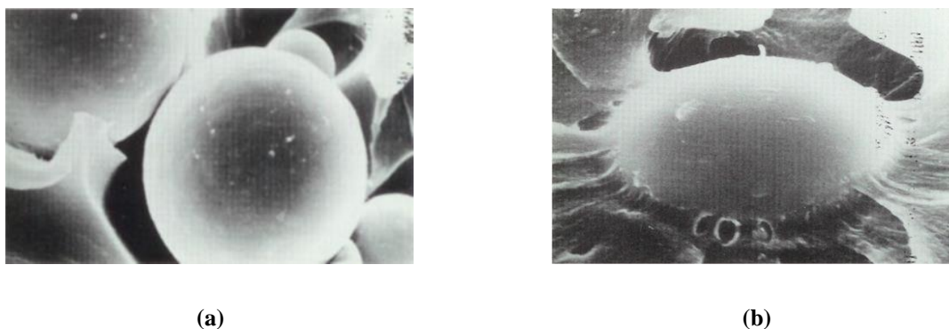
Figure 37 – Effet d'un agent de couplage sur la qualité de l'adhésion interfaciale qui est (a) mauvaise entre un liant organique et une microsphère non traitée et (b) excellente entre un liant organique et une microsphère revêtue (Images Potters).
