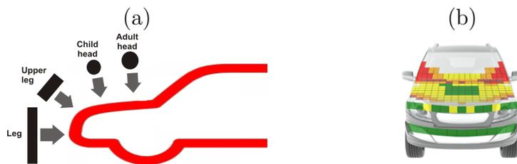
**Figure 1.1** – Essai choc piéton de l'Euro NCAP (a) et mapping du Renault Kadjar (b)
