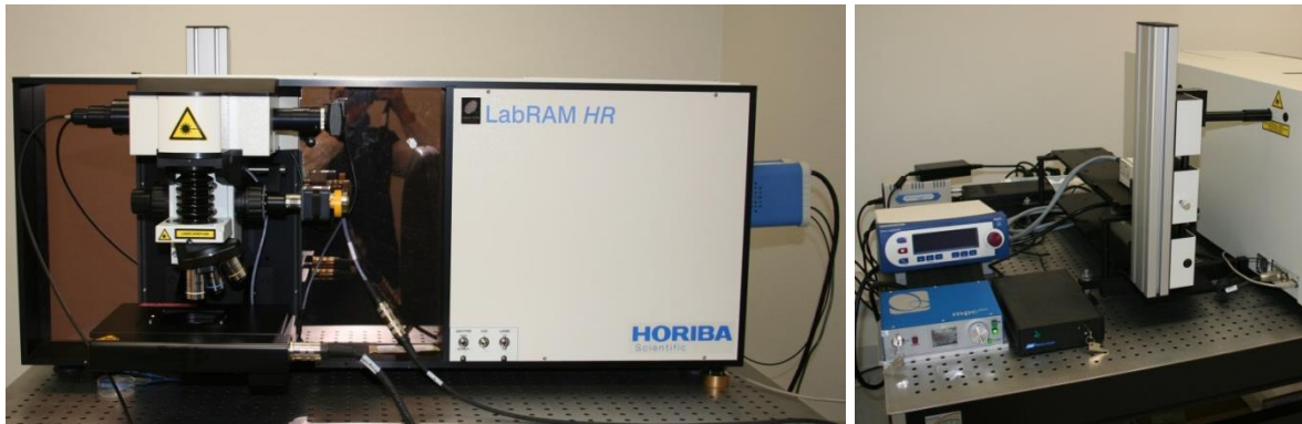
Figure 2.4 | Microscope confocal Raman LabRam HR de la plateforme IVTV utilisé pour les acquisitions Le microscope est équipé de trois sources laser 633 nm, 532 nm et 785 nm.
