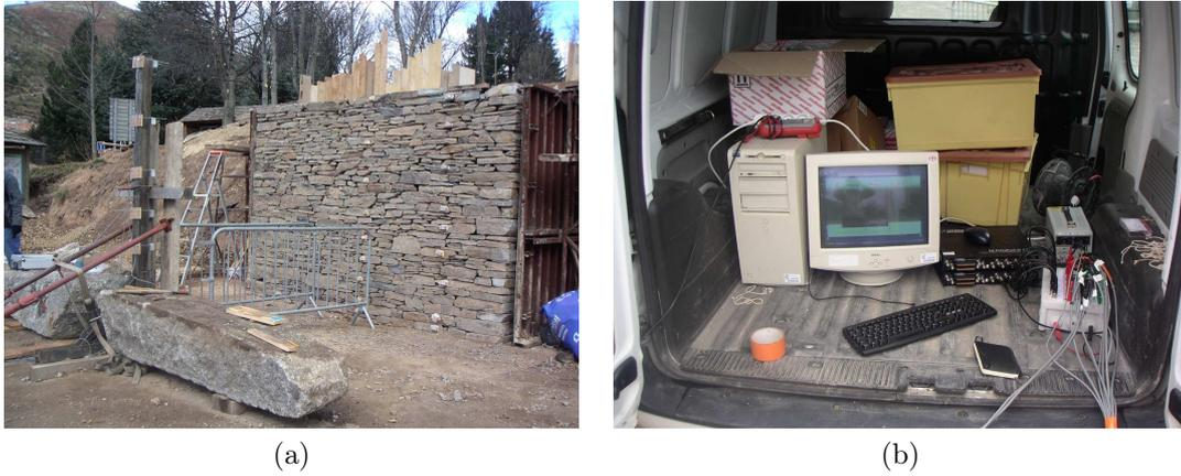
Figure 3.17 – Instrumentation des expériences *in situ* : disposition des capteurs à câble sur le mur (a) et système d'acquisition (b).
