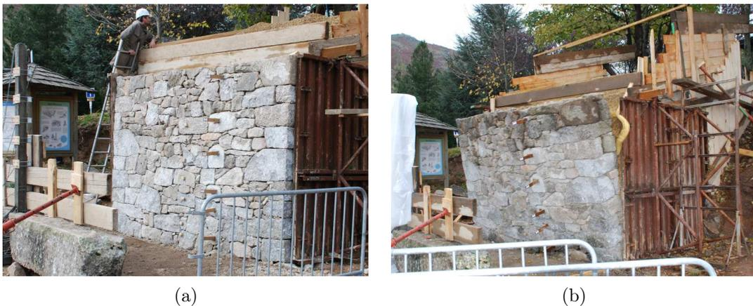
Figure 3.23 – Essai du mur C1g : préparation avant l'expérimentation (a) et chute du mur (b).
