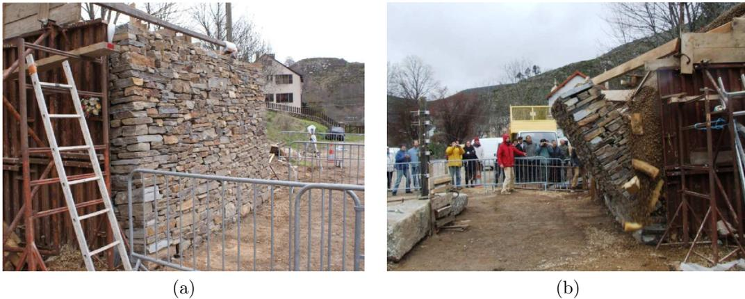
Figure 3.39 – Essai du mur C3s : préparation avant l'expérimentation (a) et chute du mur (b).
