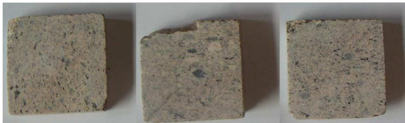
Figure 3.9 – Épontes de granite  $6 \times 6 \times 1$  cm pour les essais à la boîte de Casagrande.
