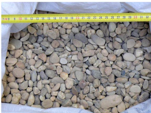
Figure 3.4 – Gravier roulé 8/16 de Bellegarde (Gard) utilisé comme remblai des murs expérimentaux.
