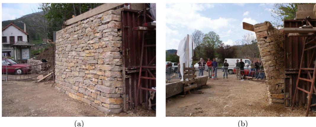
Figure 3.46 – Essai du mur C4c : préparation avant l'expérimentation (a) et chute du mur (b).
