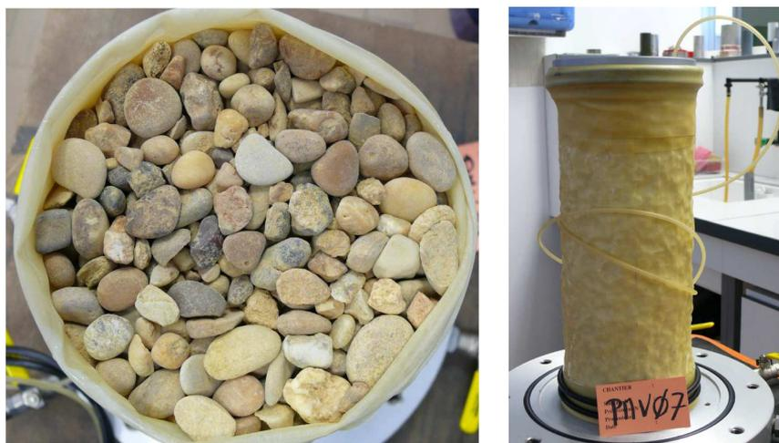
Figure 3.13 – Éprouvette ( $\varnothing = 15$  cm,  $h = 30$  cm) de gravier vue de dessus (a) et vue de face (b).
