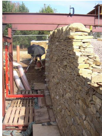
Figure 1.18 – Dispositif expérimental des essais sur murs en pierre sèche de Mundell (2009).
