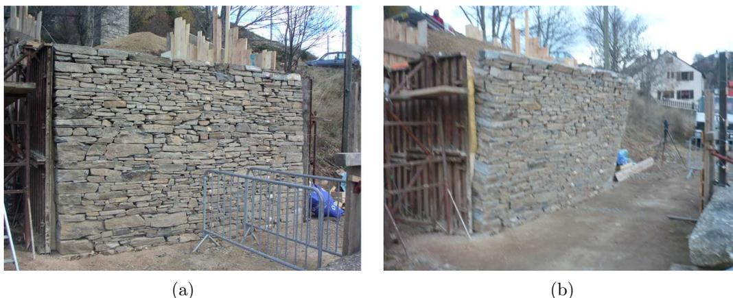
Figure 3.27 – Essai du mur C2s : préparation avant l’expérimentation (a) et chute du mur (b).
