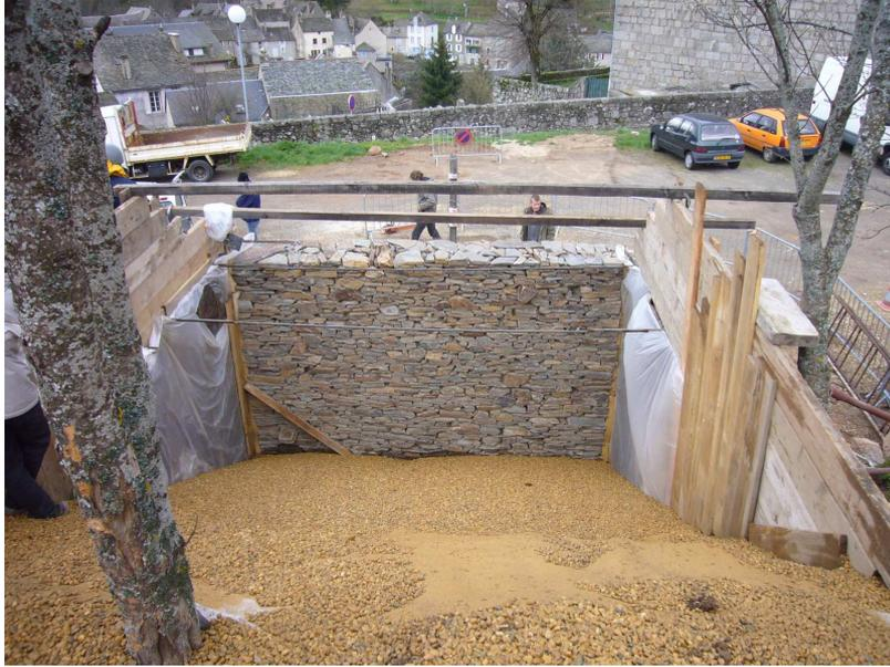
Figure 3.16 – Dispositif de chargement des murs expérimentaux.
