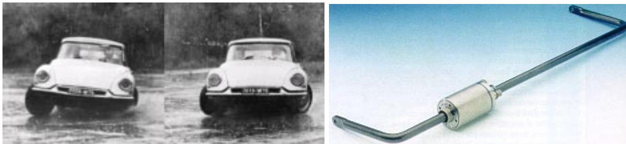
Fig. 3.14: Premier prototype d'anti-roulis actif - Vérin hydraulique rotatif au centre de la barre anti-roulis
