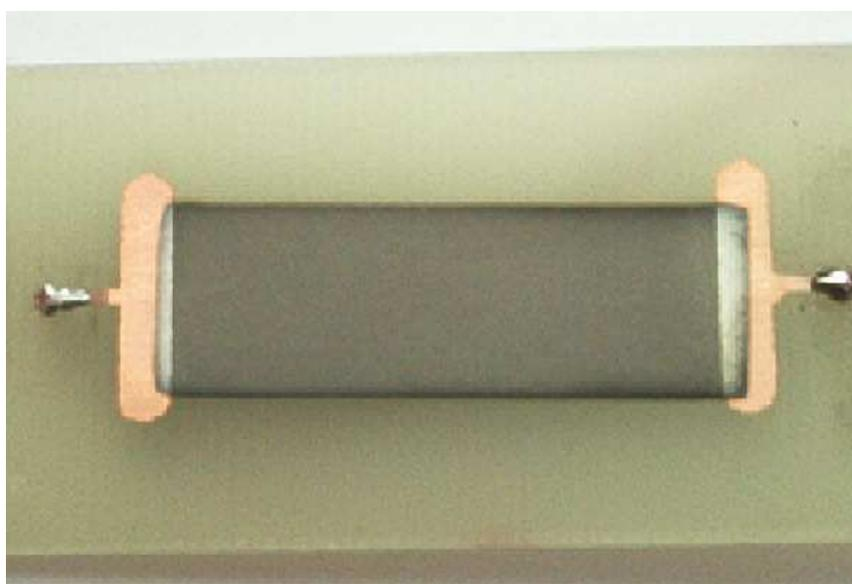
FIG. 2.4 – Film de platine évaporé sur une plaque de circuit imprimé (support en résine epoxy.) [91].
