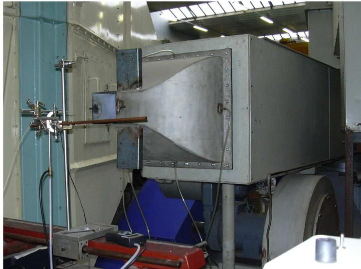
FIG. 3.3 – Image de la soufflerie utilisée pour les mesures avec un écoulement laminaire.
