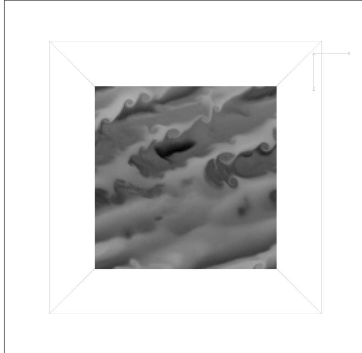
FIG. 3.51 – Plan horizontal : réalisation MICROOCÉANCALME. La figure ci-dessus représente la valeur de la flotabilité à t = 16.6 pour la réalisation MICROOCÉANCALME ( \epsilon = 0.2 , Ri = 0.5 et Re_\lambda(0) = 49 ). Le cube est coupé suivant l'horizontale. La couleur blanche représente la flotabilité positive (maximum \approx 10 ) tandis que la couleur noire représente la flotabilité négative (minimum \approx -10 ).
