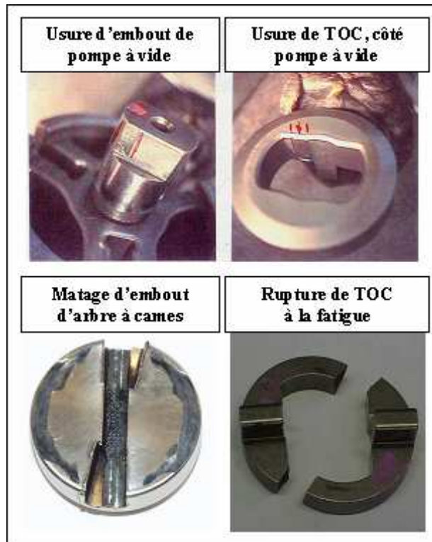
Figure 3.2 : Conséquences possibles des chocs dans l'entraînement de pompe à vide
