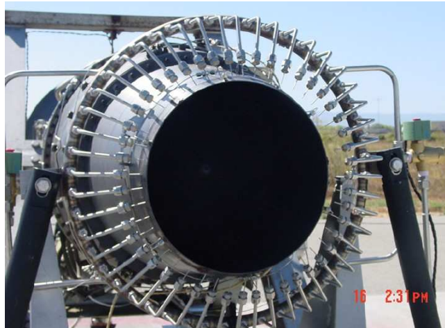
FIG. 1.3 – Configuration d’essais de Greska et al. [37] sur un réacteur à échelle 1.
